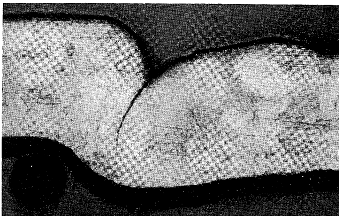
Fig. 8. b) rury miedzianej średnicy 16 mm i grubości ścianki 0,6 mm; powiększenie \times 60
