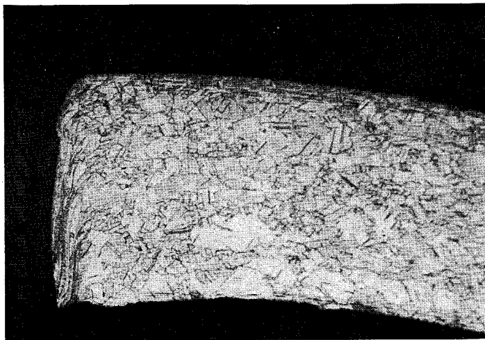
Fot. 10. Fotogramy zglądów metalograficznych złączy rury miedzianej i mosiężnej (zglądy nietrawione i trawione) a) rury miedzianej średnicy 8 mm i grubości ścianki 0,5 mm; powiększenie \times 12,5 , \times 65 , \times 125
