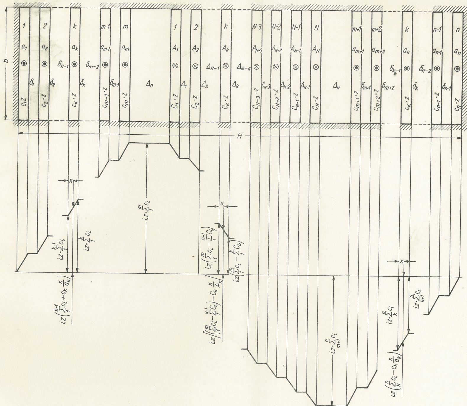
Rys. 2. Rozmieszczenie cewek w oknie transformatora i rozkład przestrzenny amperozwojów wzbudających strumień rozproszenia
