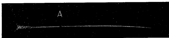
Rys. 11. Potencjał metalowej ścianki wtrąciny niższy od potencjału przeciwległej ścianki utworzonej przez dielektryk
