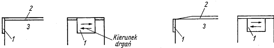
Rys. 10. Generacja fal Love'a za pomocą przetwornika piezoelektrycznego na drgania poprzeczne:
