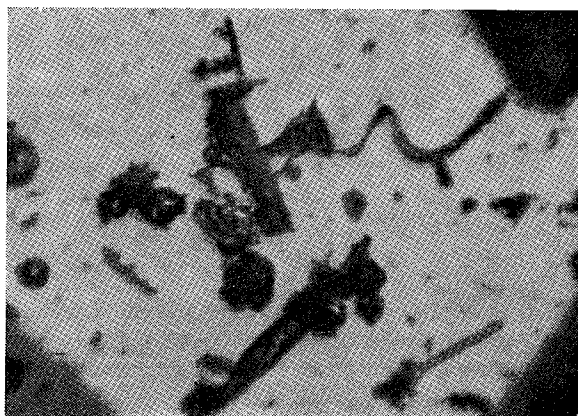
Rys. 4. Produkty zużycia kolektora powstałe w wyniku skrawania (wióry) powierzchni ślizgowej (powiększenie \beta = 300 )
