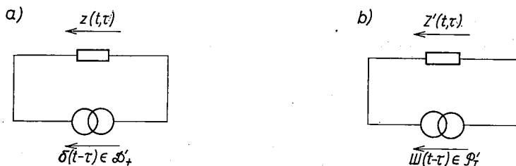
Rys. 1. Schematy do określenia jąder z(t, r) i Z'(t, r) operatorów impedancji
