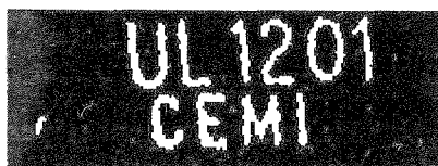
Rys. 16. Obraz układu UL1201 po operacji maskowania
