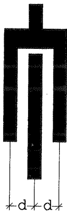
Rys. 4. Konfiguracja elektrod do pobudzania drgań modów n_{01} i n_{10}
