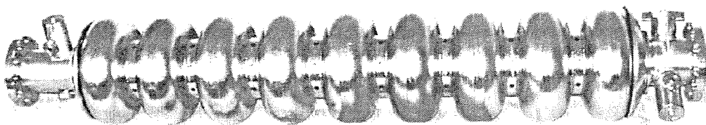
Rys. 1a . Fotografia jednej dziewięciokomorowej sekcji niobowego, wąskopasmowego falowodu dla 1,3 GHz, [1]. Taka sekcja jest nazywana wnęką rezonansową. Widoczne połączenia do następnych sekcji falowodu oraz sprzęgacz dużej mocy i sprzęgacz dla sondy pomiarowej mocy propagowanej w przód i mocy rozproszonej wstecz. Każda komora ma długość połowy fali. Pomiędzy komorami widoczne kołnierze usztywniające w celu minimalizacji drgań falowodu
